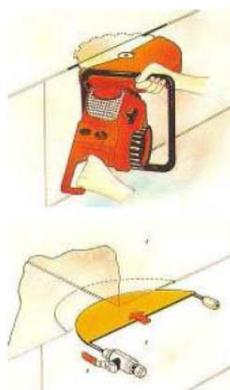
Figura 2: Apparecchiatura per la prova di martinetto semplice
